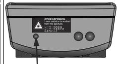
Die kleinere Öffnung (links) an der Frontseite der Fernbedienung ist die Laserstrahl-Austrittsöffnung.
