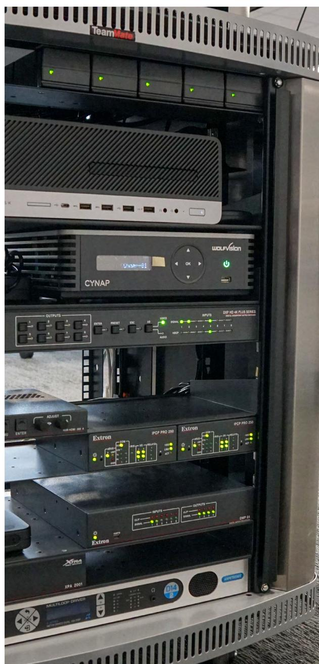
Cynap-Haupteinheit mit vSolution MATRIX-fähigen Lösungen in einem 19“-Gehäuse eines TeamMate Educator-Schranks.
