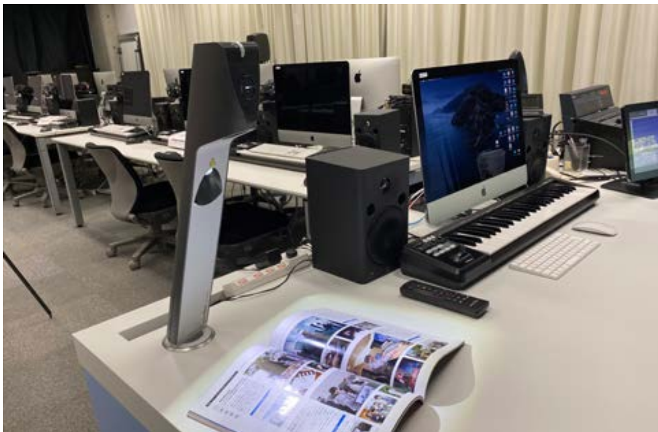
サウンド実習室：レクチャー卓に直接取り付けられたビジュアルライザー / VZ-3neo
